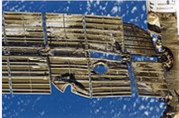
Beschädigungen an einem der Solarpanels des Spektr-Moduls nach der Kollision mit einem Progress-Raumfrachter
